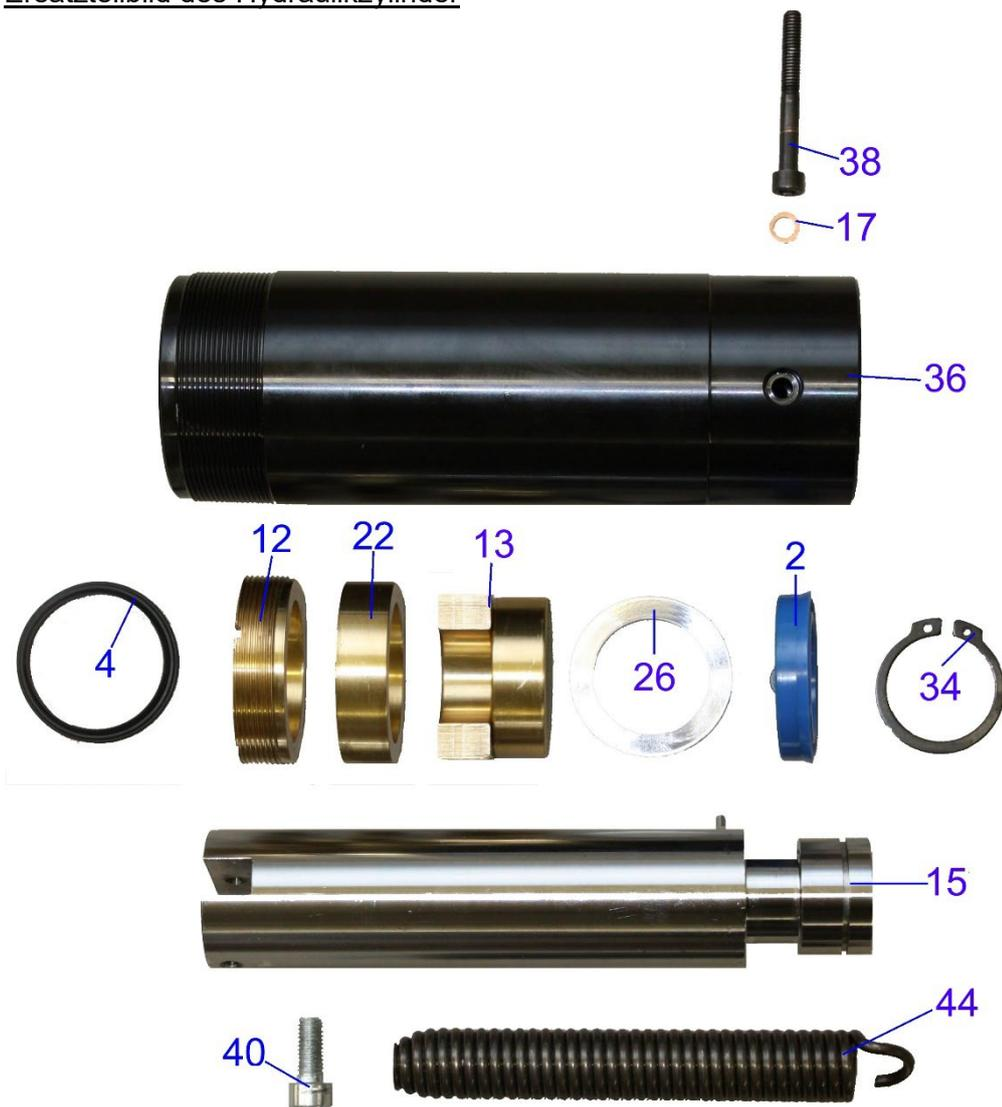
9.5.4.2 Ersatzteilliste zu Hydraulikzylinder
